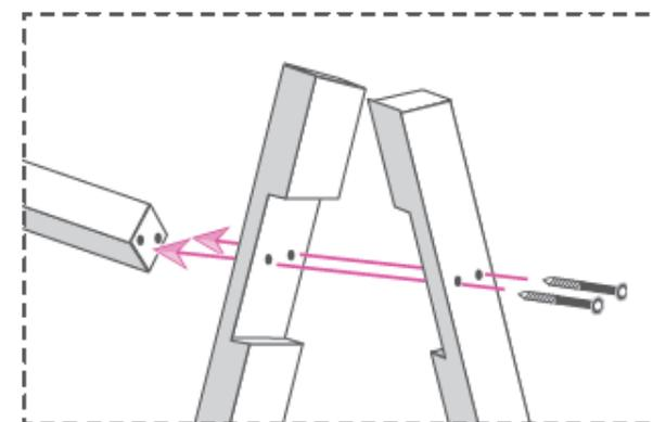
Emboîter les pan obliques soigneusement. Il ne doit rester aucun jeu.
