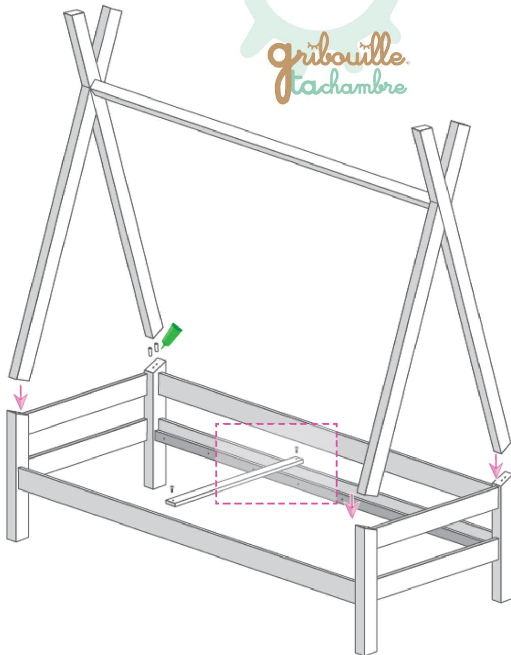
Positionnez le montant de maintien d'espace, il doit être parfaitement plaqué contre les 2 parois
