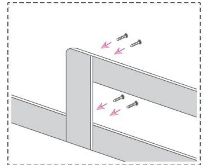
Pour l'élément vertical de barrière, utiliser les vis filletées argent à bout plat.
