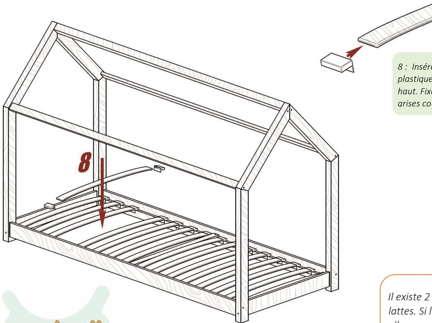
8 : Insérer les lattes dans les caches plastiques. Le bombé de la latte vers le haut. Fixer les plastiques à l'aide des vis grises courtes
